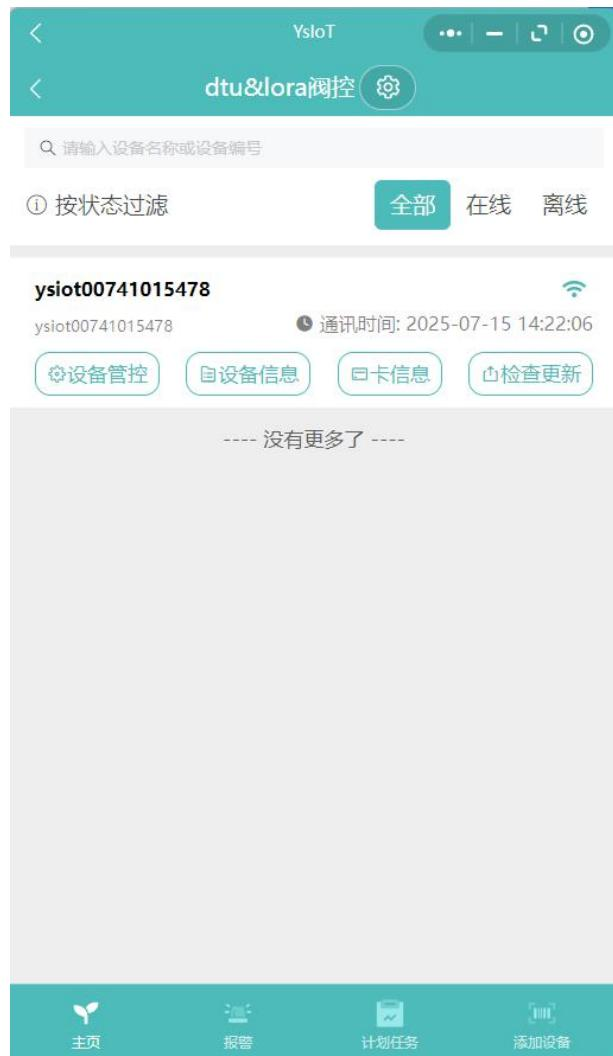
2、修改设备参数-》查看网关类型 是否 lora 网关。如果不是，配置指令输入 ‘2580’ (不加单引号),阀门类型 脉冲电磁阀 配置指令‘2590’、蝶阀 配置指令 ‘2591’。(如果对 modbus 地址和波特率有要可以直接修改。)
